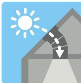
**Nesavitljivi tunel** je idealan za udaljenosti od 0.9 do 1.7 m mjereno od krova do stropa; s produžnim elementima do 6 m.
