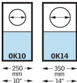
VELUX svjetlosni tuneli su dostupni u sljedećim dimenzijama:
